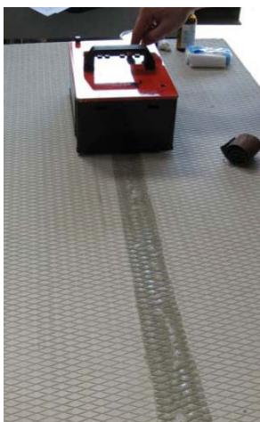
Mätkää GIAN®1 salmiakkikuviota testataan FSC 2000 laitteella
