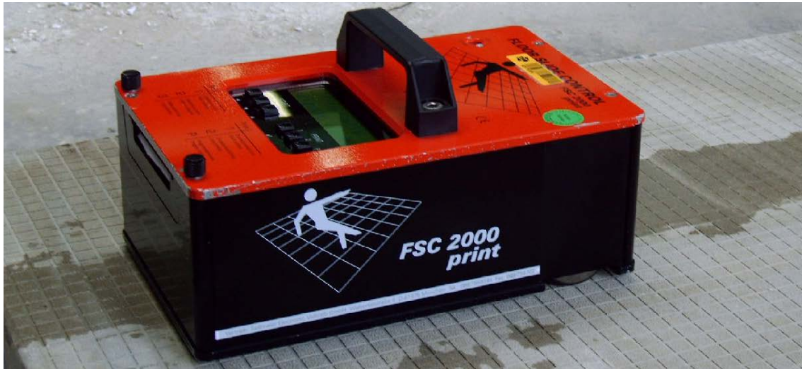
FSC 2000 printti on kätevä laite liukukitkakertoimen määrittelyyn.
