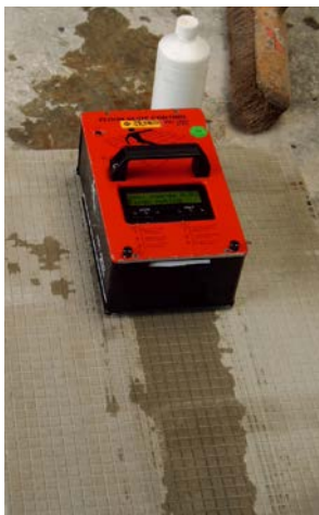
TNO:n FSC 2000 print testi märällä GIAN® 2S kuvioisella betonielementillä.
