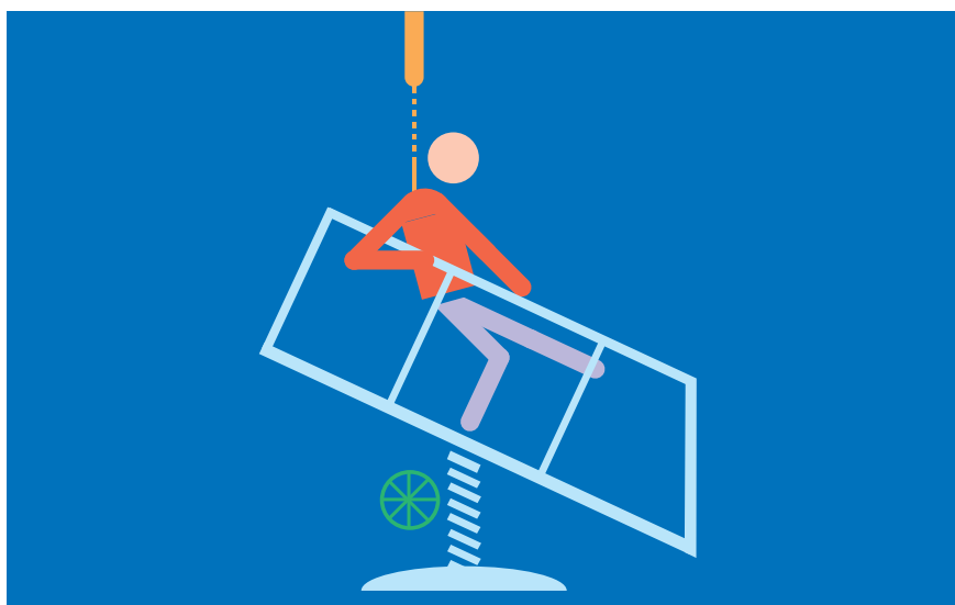
Tämän laboratoriokokeen aikana kallistetaan alustaa koko ajan enemmän. Mitä kaltevampi alusta liukumisen alkaessa, sitä korkeampi on R-arvo.
